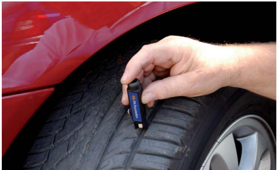
Es conveniente revisar periódicamente el desgaste desigual del neumático y el estado de las llantas. Un desgaste desigual se puede producir por una presión inadecuada, con desgaste en los dos bordes externos de la banda de rodadura o en el centro; por una alineación incorrecta de las ruedas, con desgaste por un solo borde de la banda de rodadura; o por mal estado de la suspensión que puede dar lugar a desgastes irregulares.
