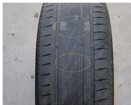
**Desgastes irregulares debidos principalmente a una suspensión en mal estado.**
