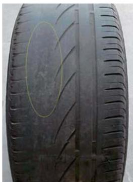
**Desgaste por un solo borde de la banda de rodadura, debido a una alineación incorrecta del neumático.**
